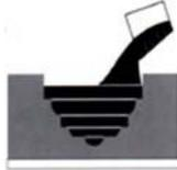
Con el molde situado sobre una superficie plana y nivelada, vierta lentamente el material de colada en el molde, manteniendo el recipiente de material tan próximo a éste como sea posible. Pasar una brocha, vibraciones o agitar suavemente puede ayudar a que el material de colada fluya hasta rellenar todas las fisuras.
