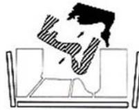
Desmonte la caja. Retire el contramolde y taladre en él un orificio de relleno y varios de escape de aire. Quite la plastelina y la envoltura de plástico o papel de aluminio del original.
