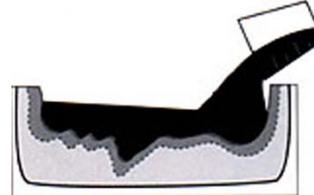
Vierta lentamente el material de colada en el molde, manteniendo el recipiente de material tan próximo a éste como sea posible. Pasar una brocha, vibraciones o agitar suavemente contribuirá a que el material de colada fluya hasta rellenar todas las fisuras.
