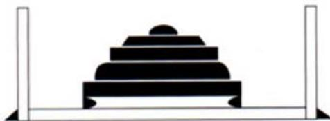
Construya la caja en torno al original. Con mucho cuidado, impermeabilice los bordes de la caja y el espacio entre el original y la caja con cera para modelos (ornamentación) sin azufre, o con plastelina sin agentes inhibidores. Esto es necesario para impedir que salga el caucho de silicona fluida. Si desea obtener piezas con un acabado liso y muy brillante, asegúrese de que el original esté bien pulido.
